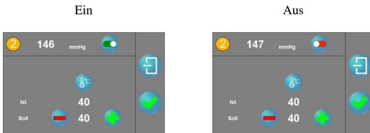
Die deaktivierten Sensoren werden durch „**Bindestriche**“ im Ausgangsdisplay dargestellt. Diese Einstellung ist während einer laufenden Messung **nicht** möglich.
